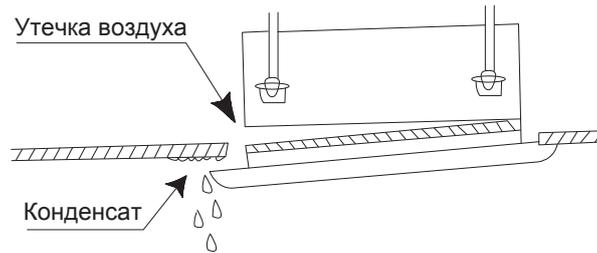
3. Если между потолком и декоративной панелью после закручивания болтов остается некоторый зазор, необходимо заново отрегулировать положение внутреннего блока.
