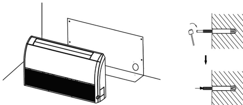
2. Вставьте анкерные болты в просверленные отверстия и молотком плотно вбейте шпильки в анкеры.
