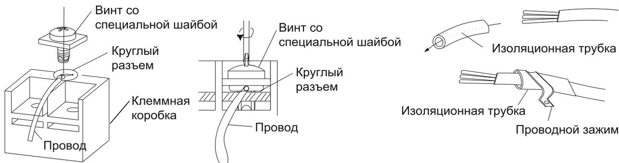
3. Зафиксируйте соединительный и силовой кабели с помощью кабельных зажимов.
