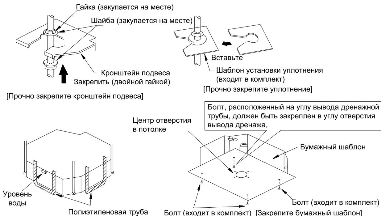
1. Установите кронштейн на болт и закрепите его гайками с шайбами сверху и снизу. Во избежание выскальзывания уплотнения используйте шаблон.
