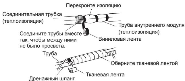
Изоляция дренажного шланга используется в том случае, если диаметр газовой трубы составляет  $\varnothing 12,70$  или больше.
