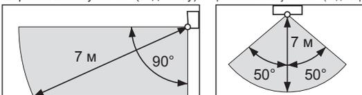
Положение датчика обнаружения людей можно поменять в соответствии с положением внутреннего блока. (См. в разделе «10. ЗАДАНИЕ НАПРАВЛЕНИЯ ДАТЧИКА ОБНАРУЖЕНИЯ ЛЮДЕЙ».)
