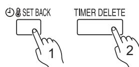
Нажмите кнопку SET BACK (СПЕЦ. ТАЙМЕР), а затем нажмите кнопку TIMER DELETE (УДАЛЕНИЕ ТАЙМЕРА), пока отображается экран подтверждения SET BACK. Даже если повторно нажать на кнопку SET BACK (СПЕЦ. ТАЙМЕР), таймер специальной температуры SET BACK будет отключен.
