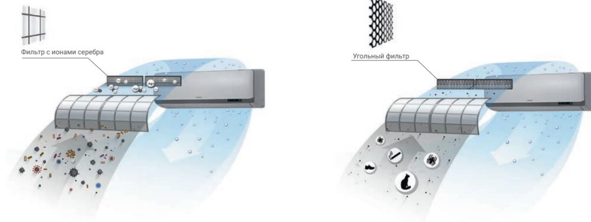
**Фильтр с ионами серебра** способствует эффективному очищению воздуха от микробов. Ионы серебра, содержащиеся в данном фильтре, прикрепляются к клеткам микробов и эффективно их нейтрализуют, способствуя оздоровлению воздуха в доме.
