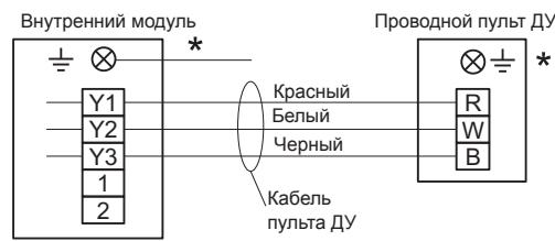
\*Заземлите пульт ДУ, если у него есть провод заземления.
