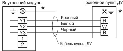
\*Заземлите пульт ДУ, если у него есть провод заземления.
