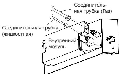
(3) Когда конусная гайка затянута рукой надлежащим образом, удерживайте сторону корпуса, скрепленную с гаечным ключом, и затяните гайку с помощью ключа с ограничением крутящего момента. (См. в таблице внизу моменты затяжки конусных гаек.)
