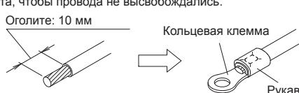
(3) Надежно подключите указанные провода и закрепите так, чтобы на клеммах не было натяжения.
