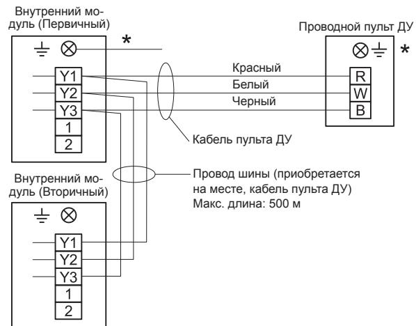
\*Заземлите пульт ДУ, если у него есть провод заземления.
